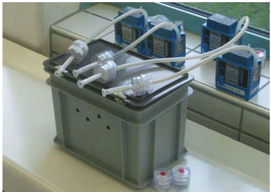
Meetopstelling voor monsternamen van o.a. chlooramine (bron: lit. [6])
